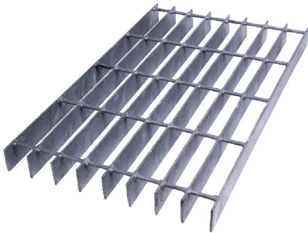
REJILLAS ELECTROFUNDIDAS TIPO RJ09 PLANCHUELA 20X2MM DM 100MM/ dm 30MM TIPO HIERROMAT
